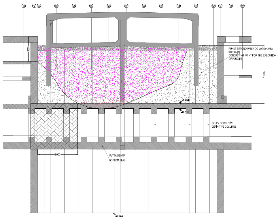
Rys. 2. Wizualizacja stwierdzonej pustki i jej zasięgu na rzucie poprzecznym przez konstrukcję tunelu Wisłostrady [materiały AGP].
