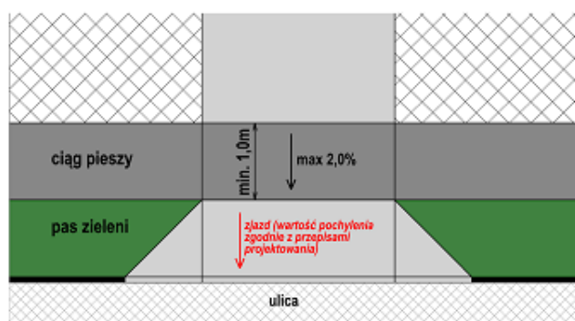
Rys. 6 Rozwiązanie zjazdu gdy jest pas zieleni.
