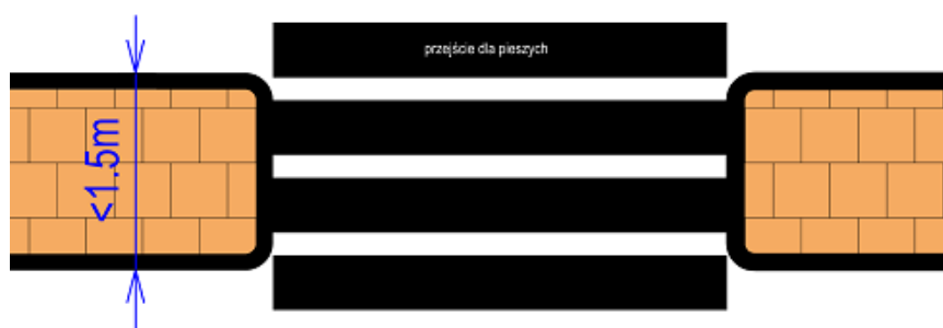
Rys. 15 Przykład rozwiązania przejścia dla pieszych przecinającego pas dzielący szerokości < 1,5 m.
