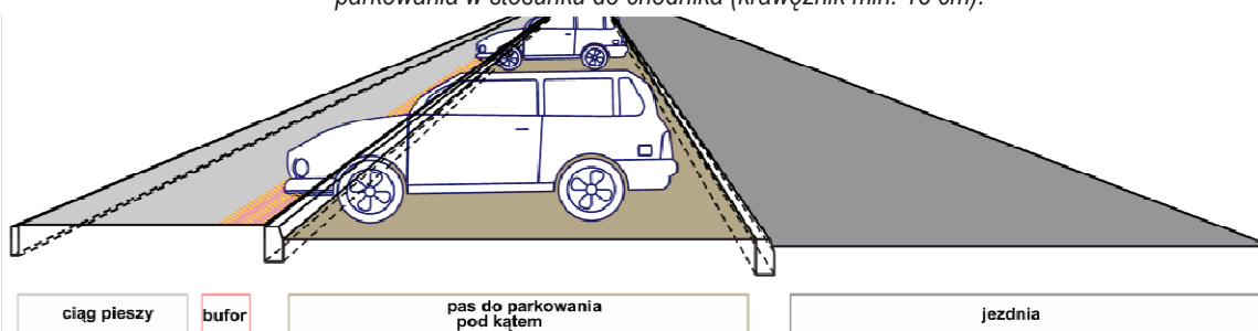
Rys. 16. Ciąg pieszki prowadzony wzdłuż miejsc do parkowania zorganizowanego „pod kątem” – segregacja bez zróżnicowania wysokości nawierzchni miejsc do parkowania w stosunku do chodnika (krawężnik do 15 cm), ale z zastosowaniem bufora bezpieczeństwa.
