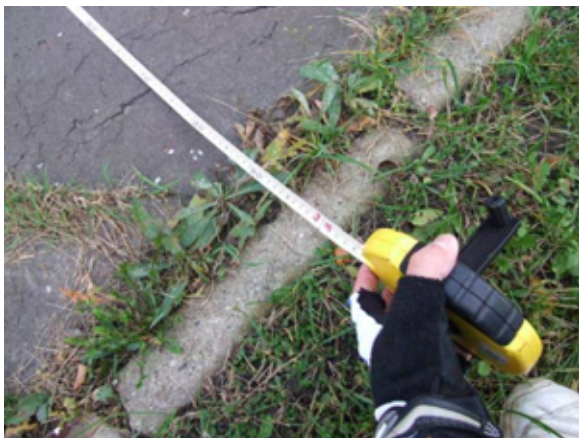
Fot. 83 – Pomiar szerokości ścieżki – 3,0m
