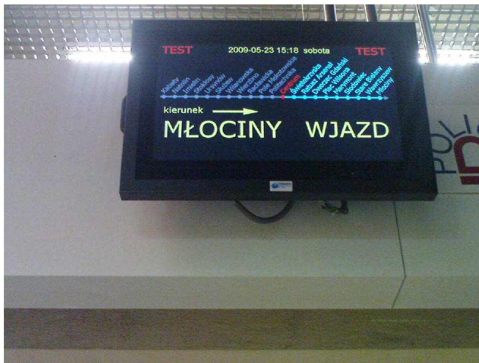
Fot. 1 Przykład dynamicznej informacji przystankowej na peronie metra w Warszawie
