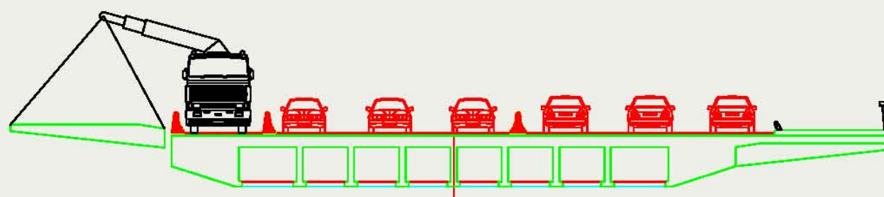
ETAP 11 MONTAŻ NOWEJ STALOWEJ WSPORNIKÓW ZA POMOCĄ DZWIGU
