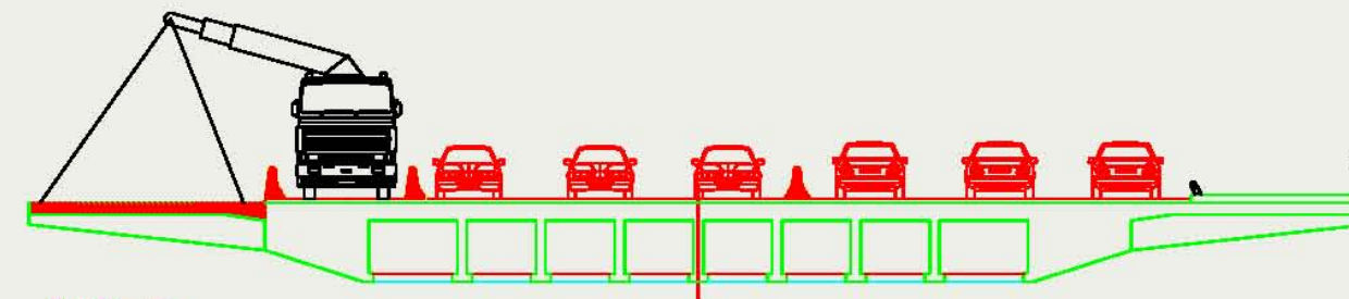
ETAP 12 WYLANIE GÓRNEJ PŁYTY BETONOWEJ
