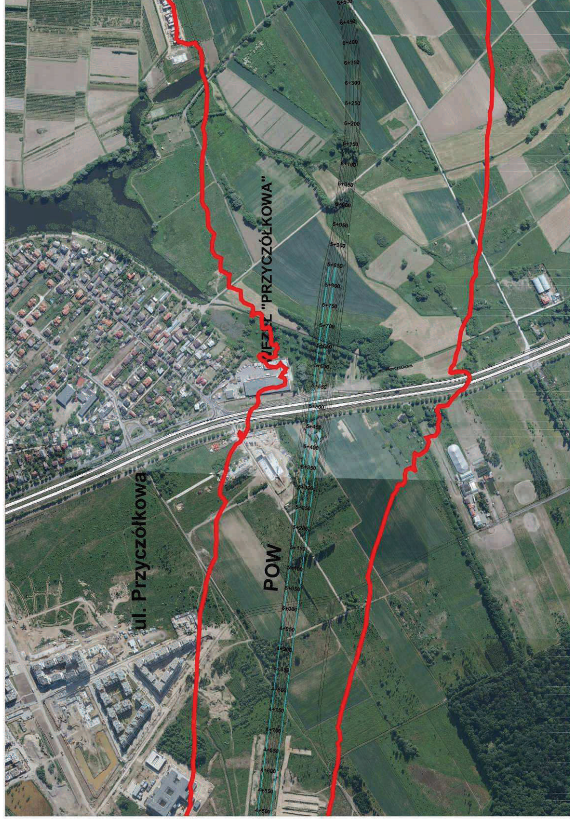
Rys. 9.4.2. Zasięg hałasu – 50 dB (pora nocna) od trasy POW – rok 2030 z zaplanowanymi zabezpieczeniami akustycznymi
