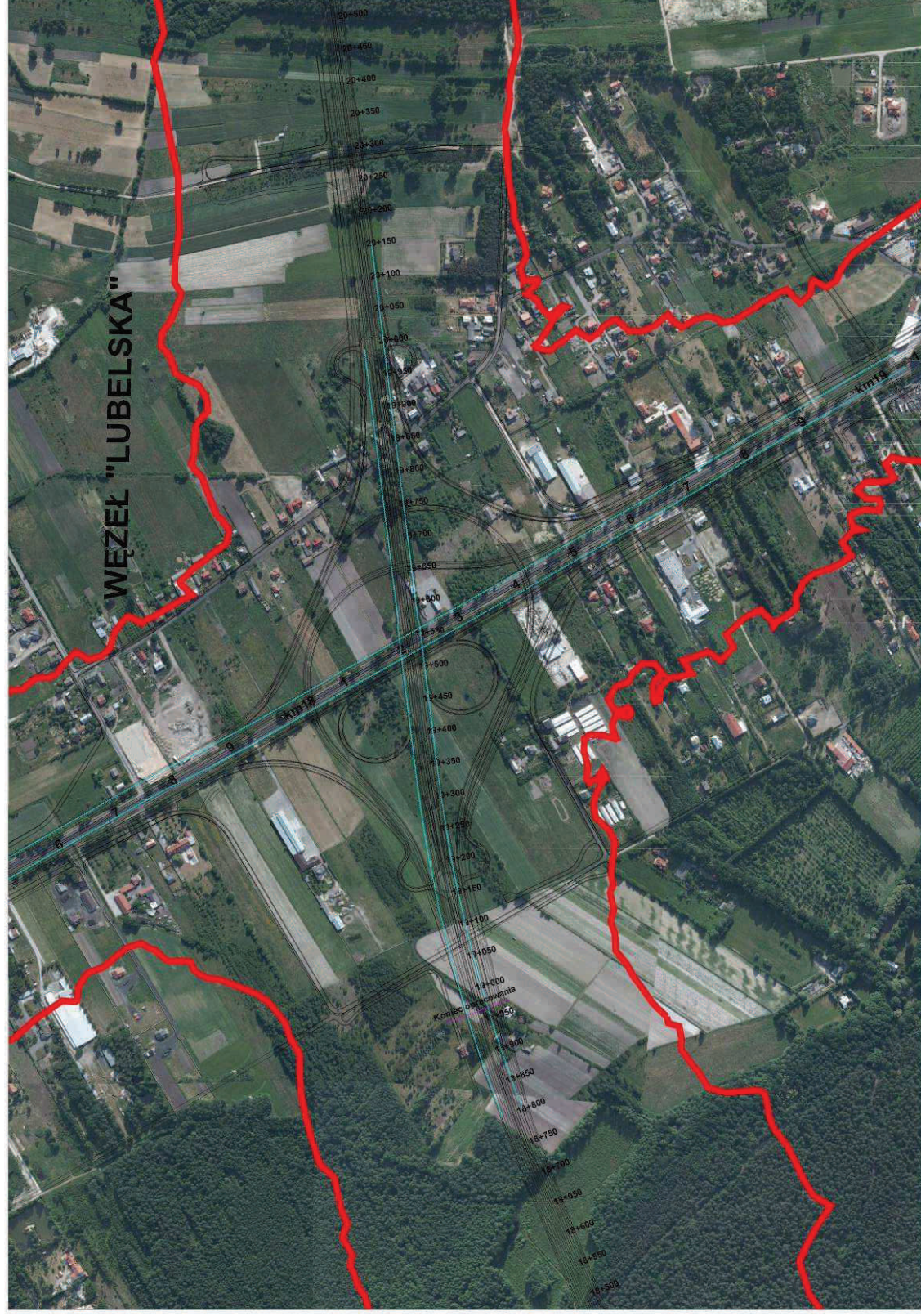
Rys. 9.4.7. Zasięg hałasu – 50 dB (pora nocna) od istniejącej DK-17 i trasy POW z zaplanowanymi zabezpieczeniami akustycznymi – rok 2030
