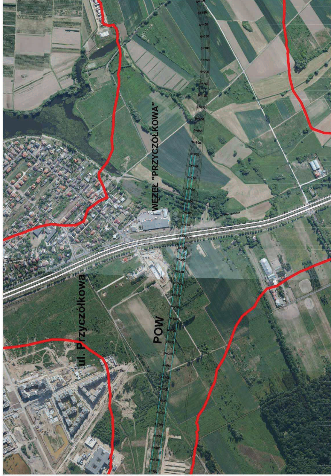
Rys. 9.4.3. Zasięg hałasu – 50 dB (pora nocna) od istniejącej ul. Przyczółkowej i trasy POW z zaplanowanymi zabezpieczeniami akustycznymi – rok 2030
