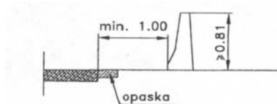
Rys. 9. Lokalizacja betonowych barier ochronnych przy krawędzi pasa ruchu z poboczem ziemnym lub z poboczem ziemnym wraz z opaską.
