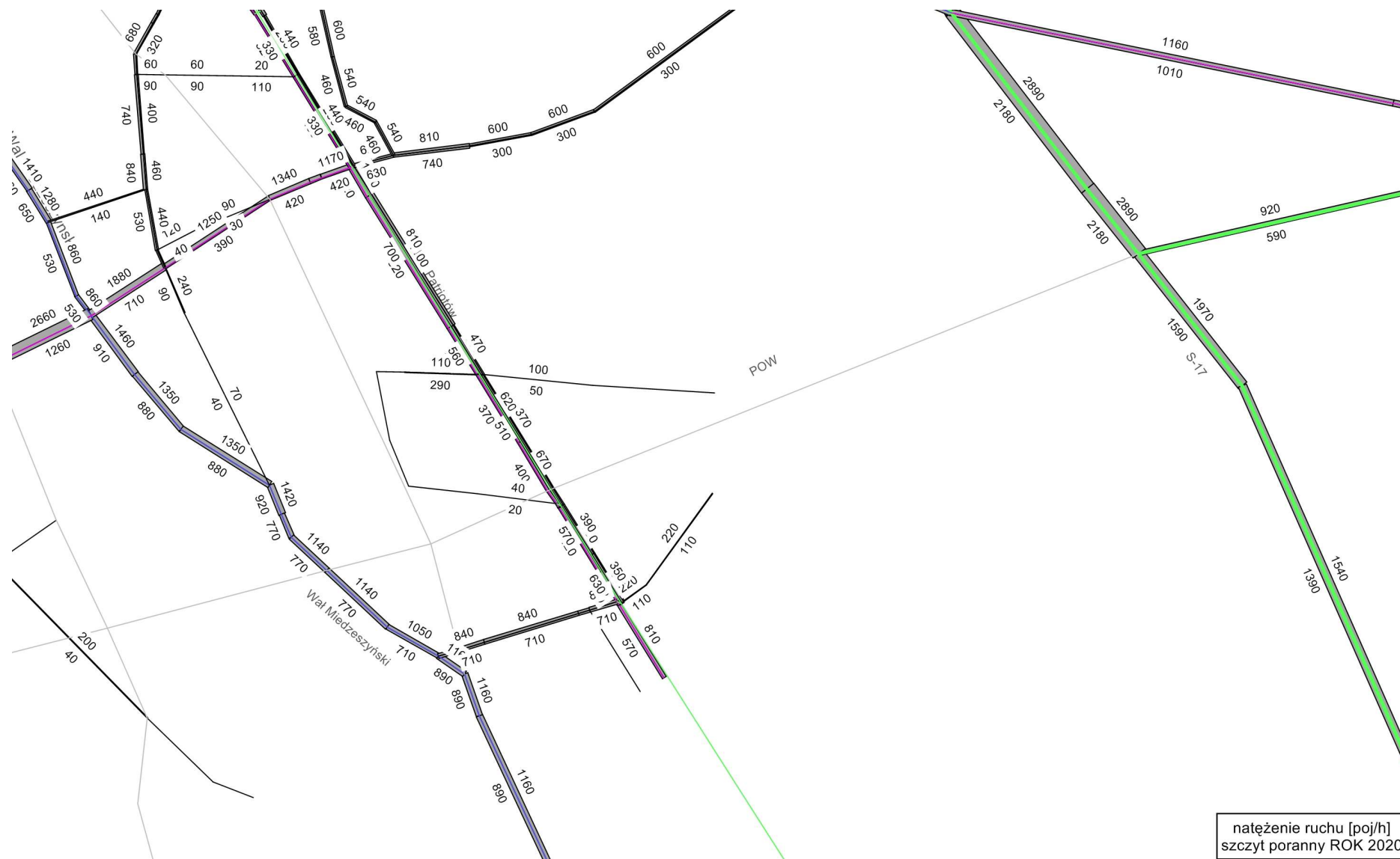
Rysunek 4.4 Natężenie ruchu drogowego w korytarzu projektowanej drogi S w roku 2020, na odcinku od mostu na Wiśle do węzła Lubelska [poj./h] – wariant 0
