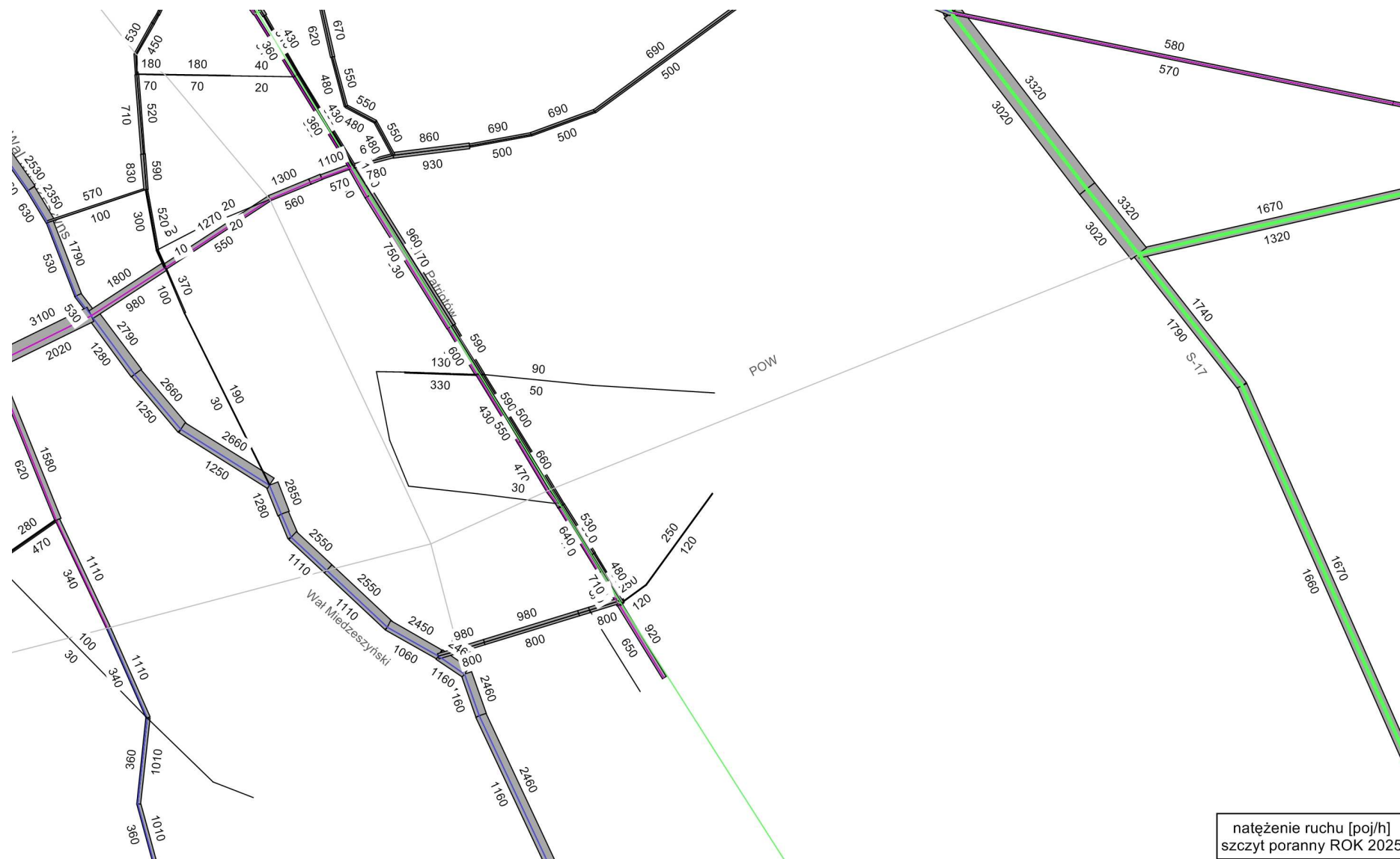
Rysunek 4.6 Natężenie ruchu drogowego w korytarzu projektowanej drogi S w roku 2025, na odcinku od mostu na Wiśle do węzła Lubelska [poj./h] – wariant 0
