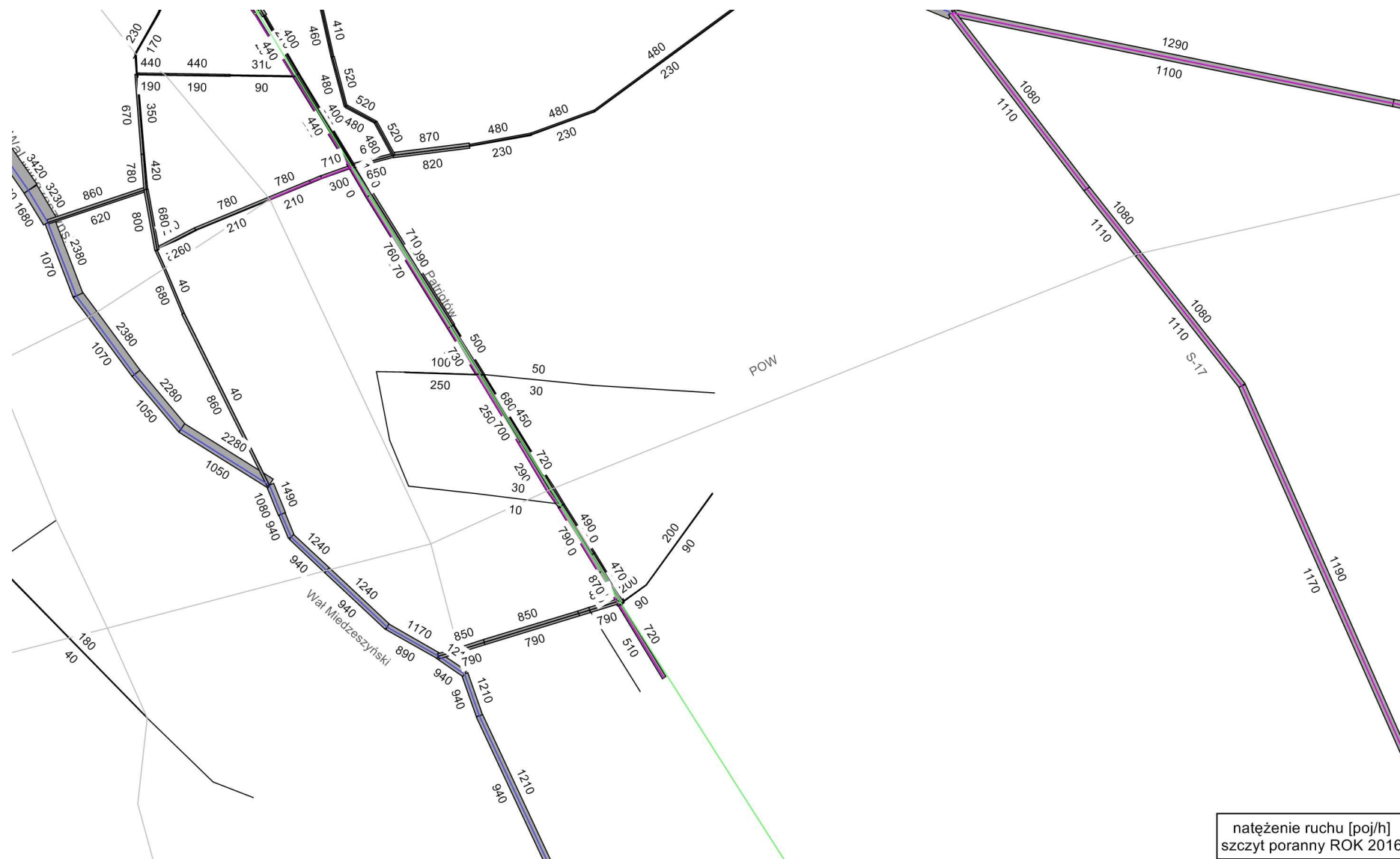
Rysunek 4.2 Natężenie ruchu drogowego w korytarzu projektowanej drogi S w roku 2016, na odcinku od mostu na Wiśle do węzła Lubelska [poj./h] – wariant 0
