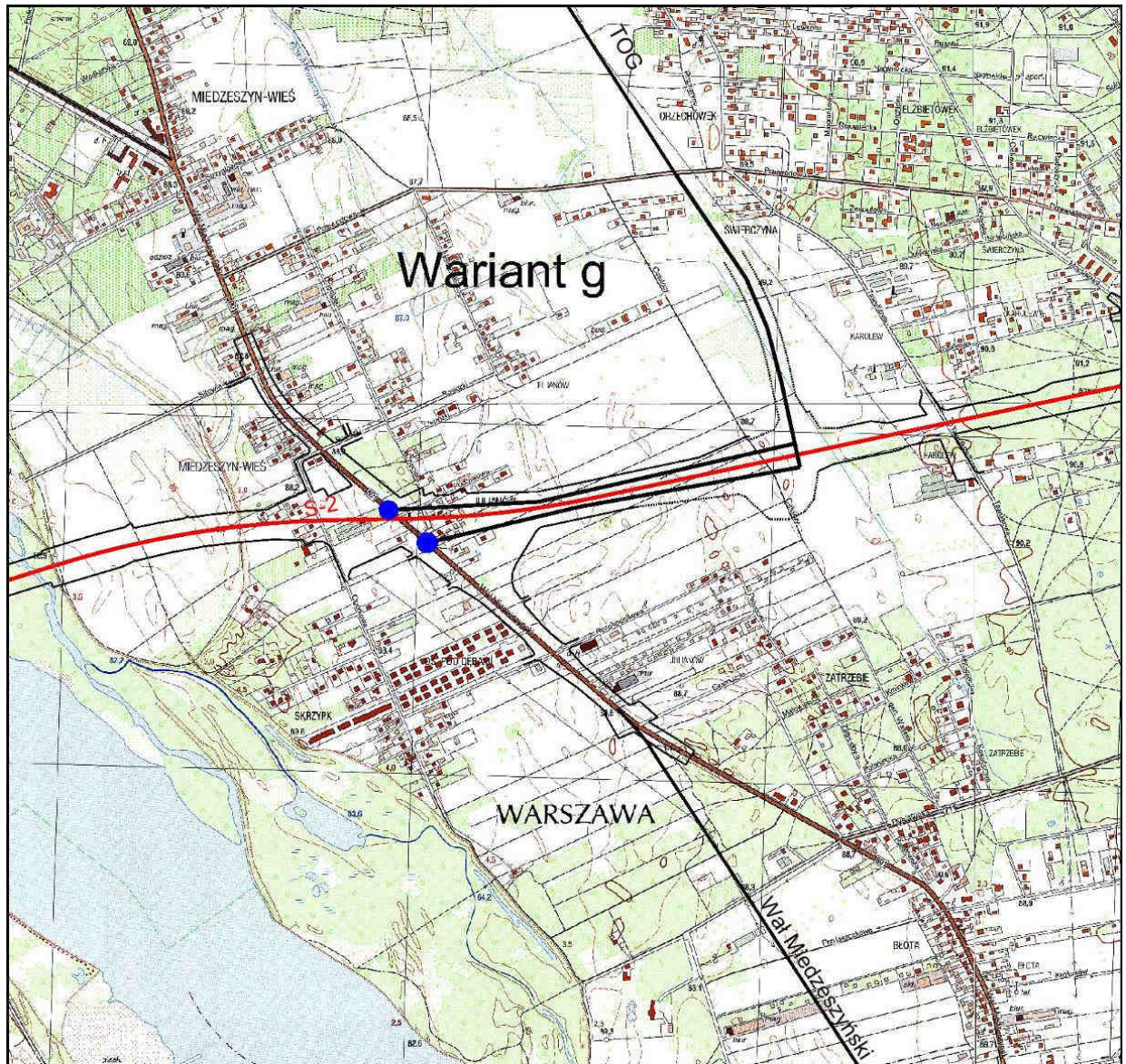
Rys. 2.7. Wariant „g” – schemat włączenia Trasy Olszynki Grochowskiej do Wału Miedzeszyńskiego w rejonie węzła z Trasą Mostu Południowego (drogą S-2)
