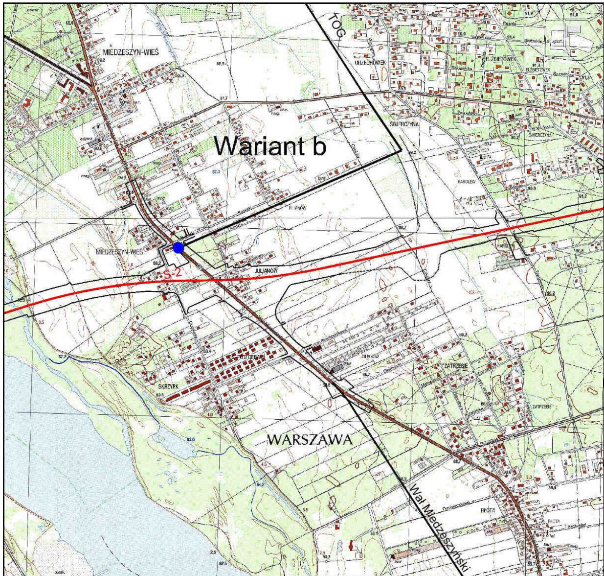
Rys. 2.2. Wariant „b” – schemat włączenia Trasy Olszynki Grochowskiej do Wału Miedzeszyńskiego w rejonie węzła z Trasą Mostu Południowego (drogą S-2)
