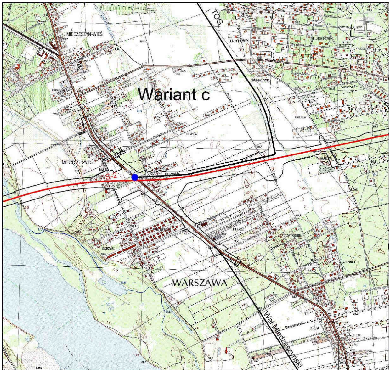
Rys. 2.3. Wariant „c” – schemat włączenia Trasy Olszynki Grochowskiej do Wału Miedzeszyńskiego w rejonie węzła z Trasą Mostu Południowego (drogą S-2)
