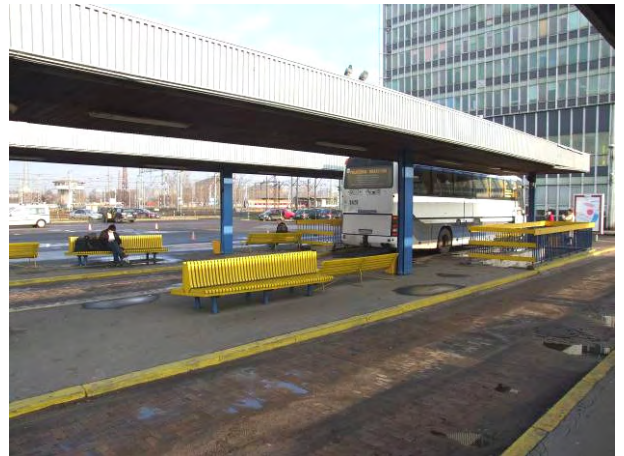
fot. 2 – Stanowiska odjazdowe od długości umożliwiającej obsługę dwóch autobusów przy jednej platformie
