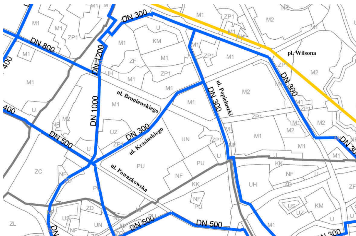
Rys. 1. Układ sieci wodociągowej w rejonie ulicy Krasińskiego
