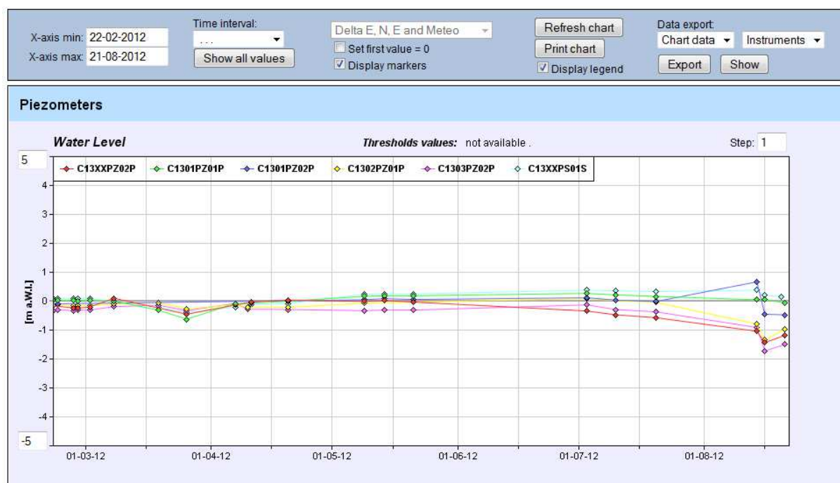
Rys. 2.7 Układ piezometrów wokół stacji C13 oraz wyniki pomiarów z.w.g. od lutego do sierpnia 2012 r [XV.6]
