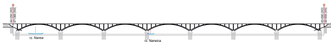
Most łukowy z jazdą górą, wykonany z betonu sprężonego WT2-W (rozstaw przęseł - 7x200m)
