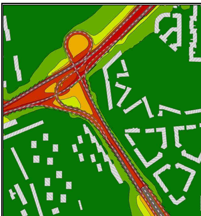
Po zastosowaniu zabezpieczeń akustycznych
